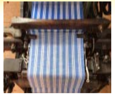
1年かけ整備した豊田式織機と会津青木木綿。一つ一つパーツを外し、油を差し、整備を行った
