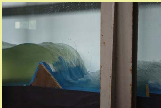
写真2 海岸堤防を越水時の状況 破堤した海岸堤防の多くは、堤防裏法が消失しており、模型実験による破堤メカニズムの解明が期待されている。
