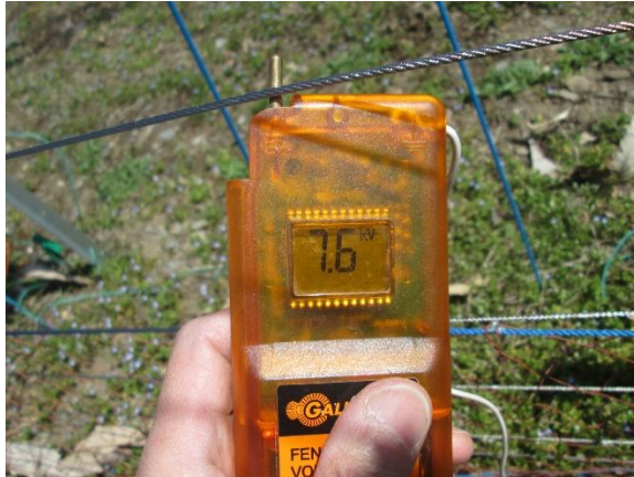
写真2 電圧テスターによる計測
