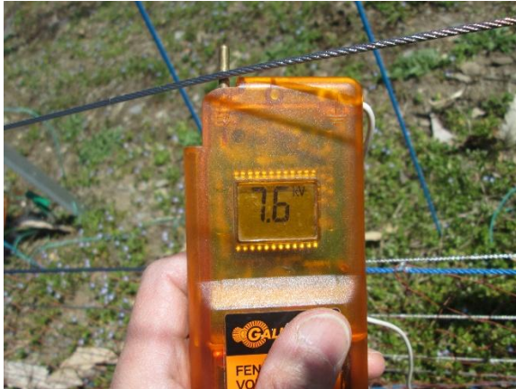
写真2 電圧テスターによる計測
