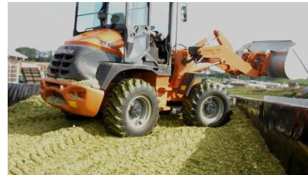
写真 3 壁に向かって踏圧する
