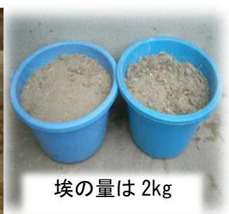
図7 換気扇掃除の効果（左：掃除前 右：掃除後（換気扇から2kgのホコリを除去）
