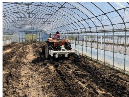
排水性の改善に向けたサブソイラによる耕盤破壊作業
