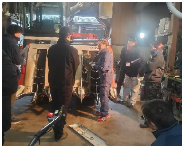
コンバインの刈り取り部分を分解し、清掃方法を説明いただきました
