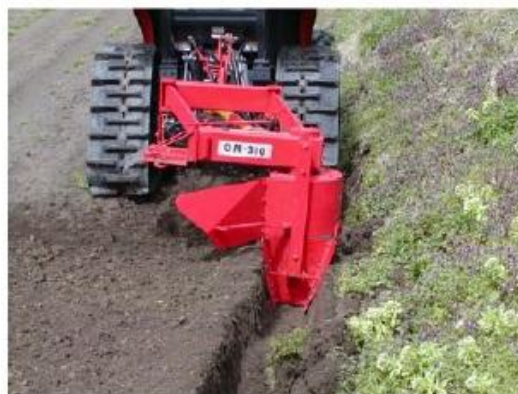
写真4 排水溝（額縁明渠）の設置 排水溝への集水は耕起土層からの流出が多いので、排水溝は耕起深より少なくとも5～10cmは深く掘ることが必要。
