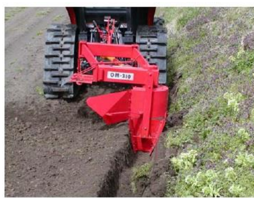
写真3 溝堀機による明渠の設置
