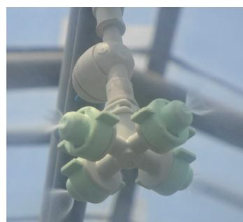
写真1 使用したミストノズル
