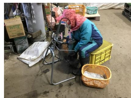
写真4：新たに導入された圧縮空気による皮むき作業（機械作業：改善後）
