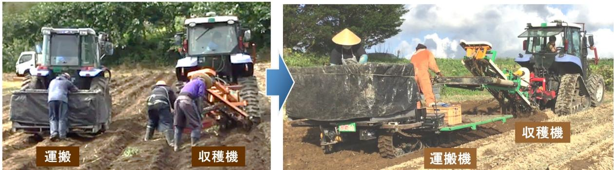
図1 ごぼう収穫作業（左 導入前：作業人員5人、右 自動操舵＋運搬機導入後：作業人員3人）
