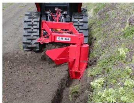
写真3 溝堀機による明渠の設置
