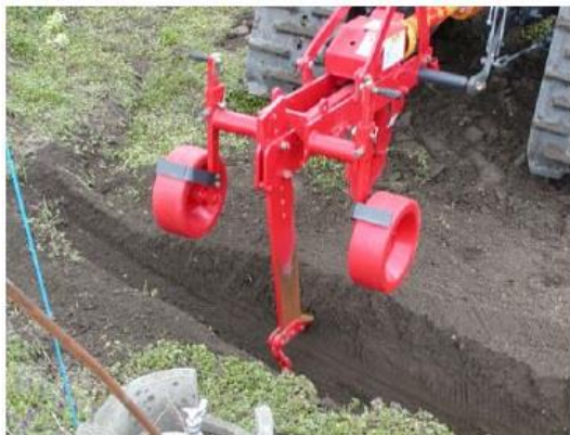
写真2 弾丸付サブソイラでの施工
