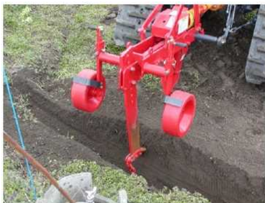
写真2 弾丸付サブソイラでの施工
