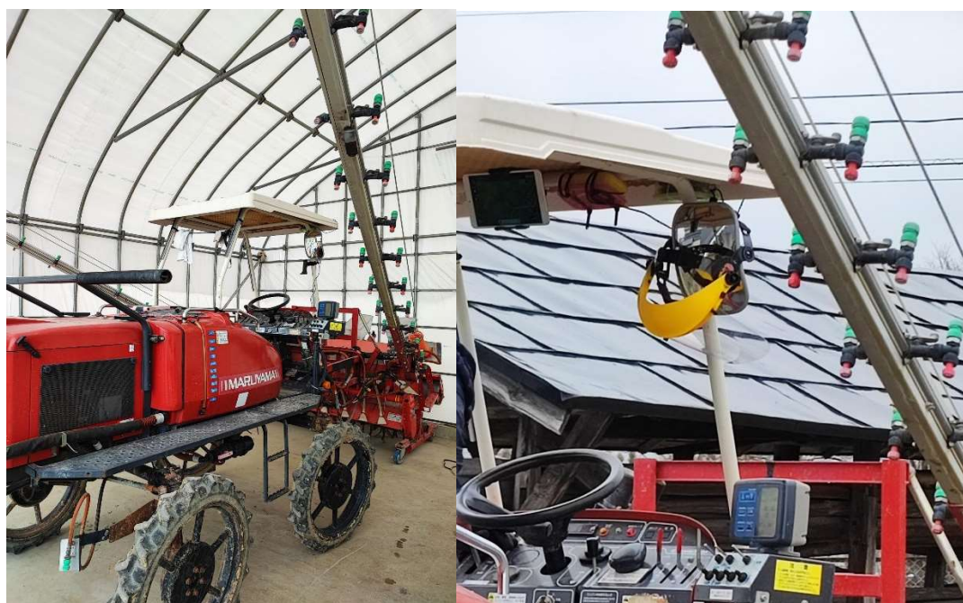
図 GNSS アンテナは屋根の中心部に設置
