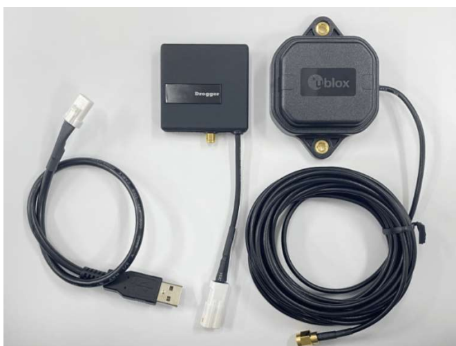
図 ジャイロやセンサを内蔵しており、設定も容易な「Drogger DG-PR01RWS」
