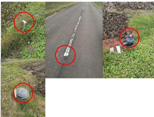
図 圃場内の構造物も GCP として利用できる (中心に GNSS アンテナをおく)。
