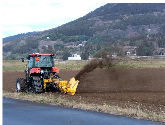
溝掘機による明渠施工実演作業の様子 (AM)
