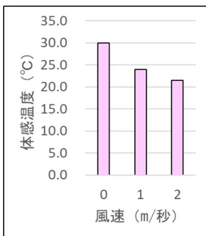
図1 気温 30°C時の風速と体感温度
