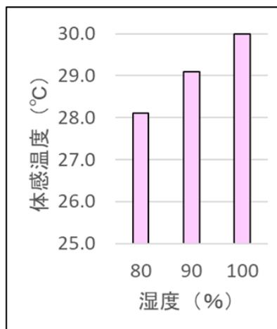
図2 気温 30°C時の湿度と体感温度
