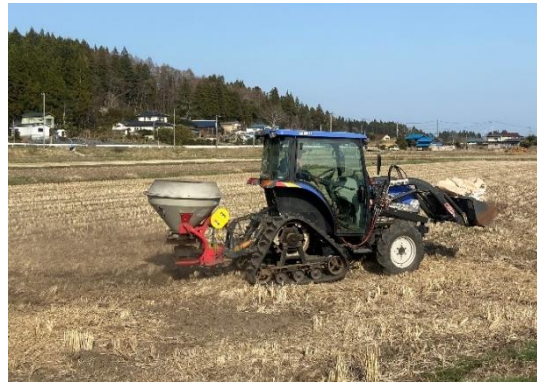
左：散布した豚ふんペレット（サイズは直径5mm×20mm程度） 右：ブロードキャスタによる豚ふんペレットの散布
