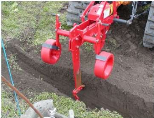
写真1 弾丸付サブソイラでの施工
