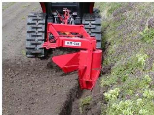
写真2 溝堀機による明渠の設置
