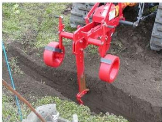
写真1 弾丸付サブソイラでの施工
