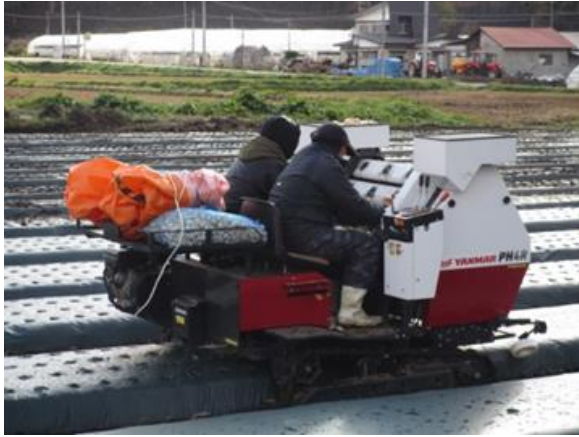
植付機による種子植え付け作業
