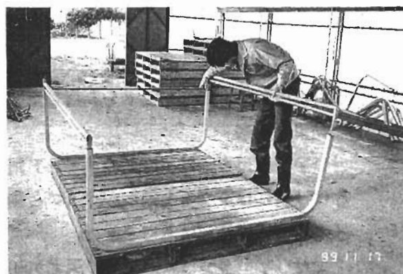
図5 U字型蚕座と組み立て状況
