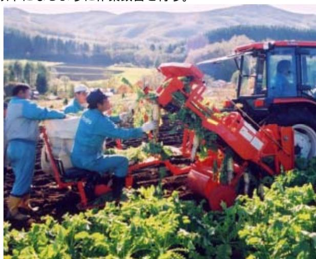
図2 トラクタ装着式大根収穫機
