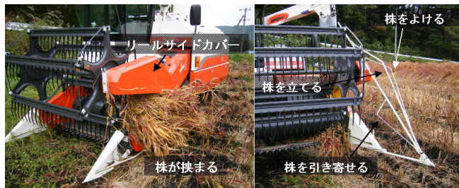
図4 デバイダ改良前のアワ収穫の様子(左)と改良後(右)
