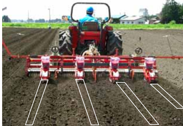
図2 スクリーンレーキ装着後の播種条表層の碎土状況
