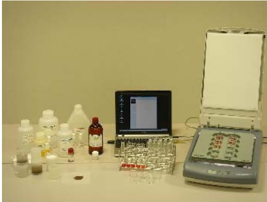
図1 デジタル土壌養分分析システムの構成
