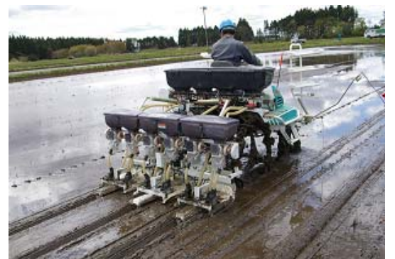
図7 側条施肥機付き作溝装置(6条)での播種状況 (金ヶ崎町 H22.5.9)
