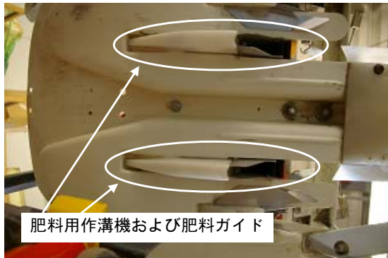
図3 泥よけ装置を付けない場合のフロート裏の状況
