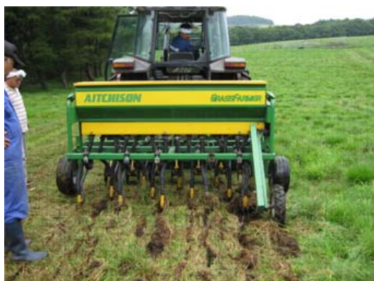
図3 作溝式播種機の写真 (エイチゾン社製 グラスファーマー)
