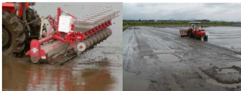
図3 代かき同時打ち込み直播機の作業状況
