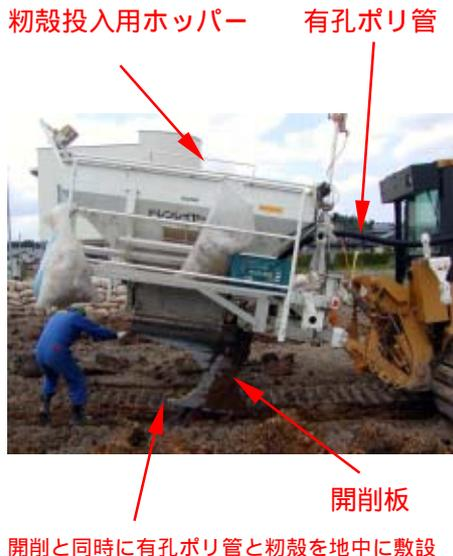
開削と同時に有孔ポリ管と初穀を地中に敷設
