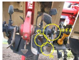
図6 乗用型管理機に装着した耕起爪の配列例
