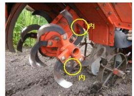
図7 歩行型管理機に装着した耕起爪の配列例
