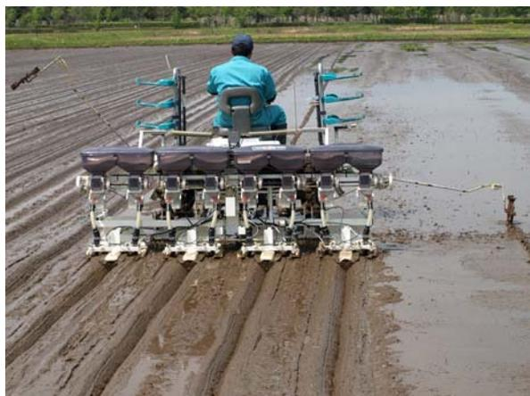
写真1 作溝装置による播種同時作業状況
