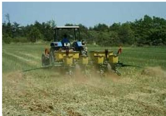
写真1 中割往復作業法における中割列の播種作業状況(両側マーカーを下げた例)
