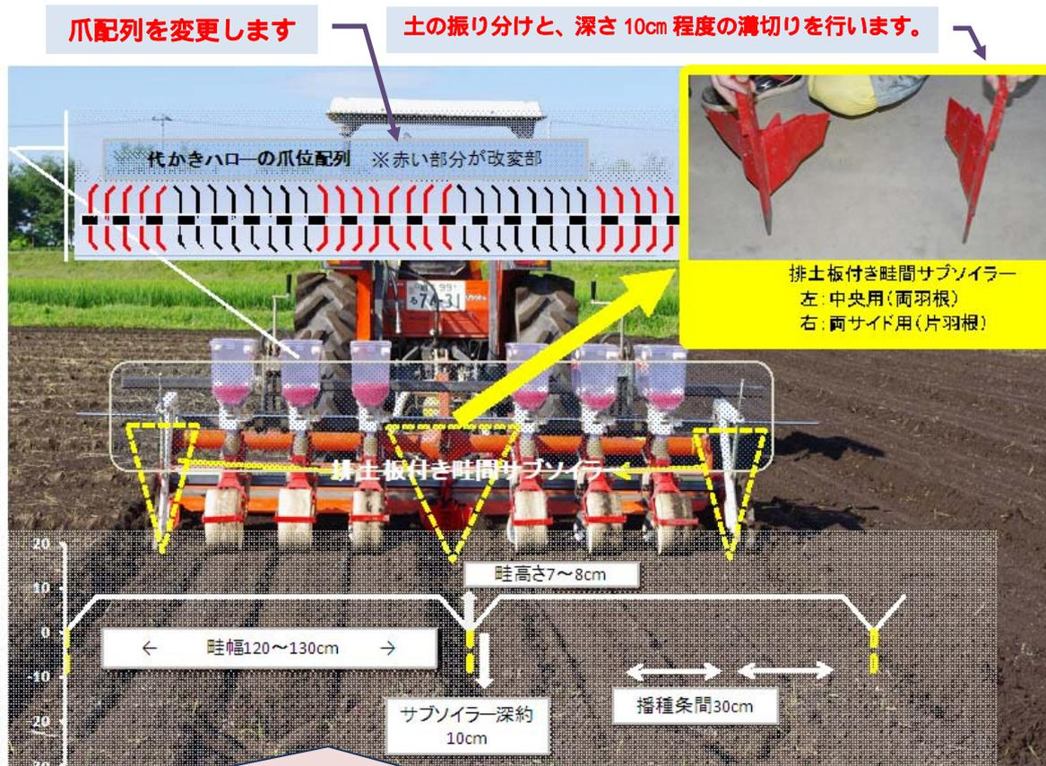
畦高さは 7 ~ 8 cm、畦間サブソイラーは溝底から約 10cm の深さに作用させることができます。作業速度は、概ね 2.0 ~ 2.5km/h です。
