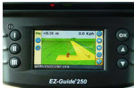
写真 トラクタ搭載型 GPS
