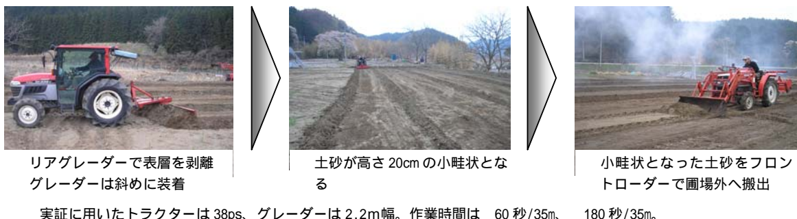
図1 堆積層の除去手順（4月30日に実施）
