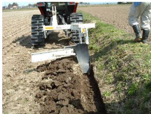
プラウ式 (例)作業速度 4.0~6.0km/時 適応トラクタ 10~100ps
