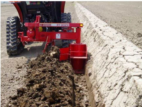
スクリーオーガ式 (例)作業速度 0.2~2.5km/時 適応トラクタ 20~60ps
