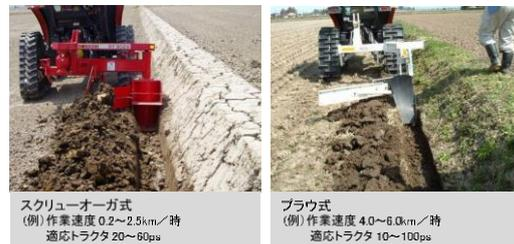
参考写真 額縁明渠の機械施工(スクリーオーガ式・プラウ式)
