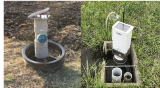
図2 圃場水管理システムの子機
