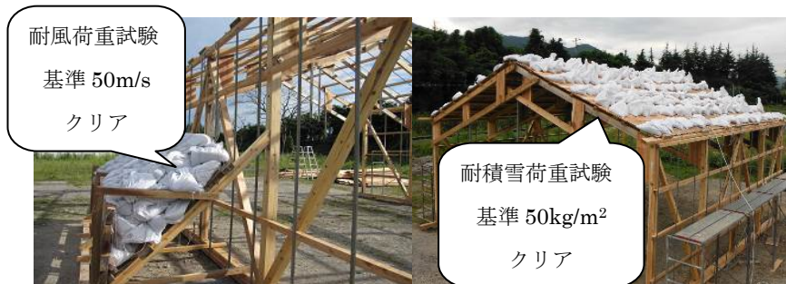
図2 木骨ハウスの耐風・耐雪性試験の様子
