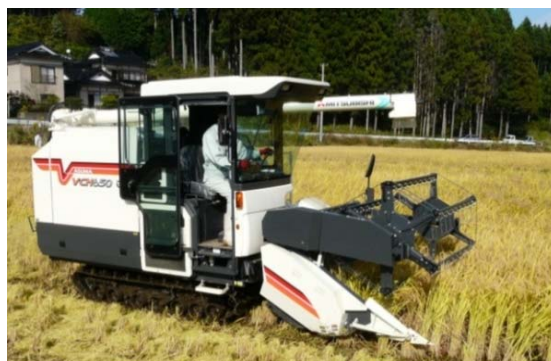
図2 小型汎用コンバイン（供試機） （M社製、VCH650）
