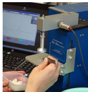
図2 炊飯米物性の測定の様子
