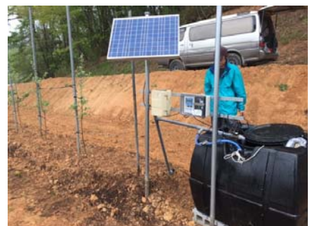
図3 ソーラー式自動かん水装置 （ソーラーパルサーE）
