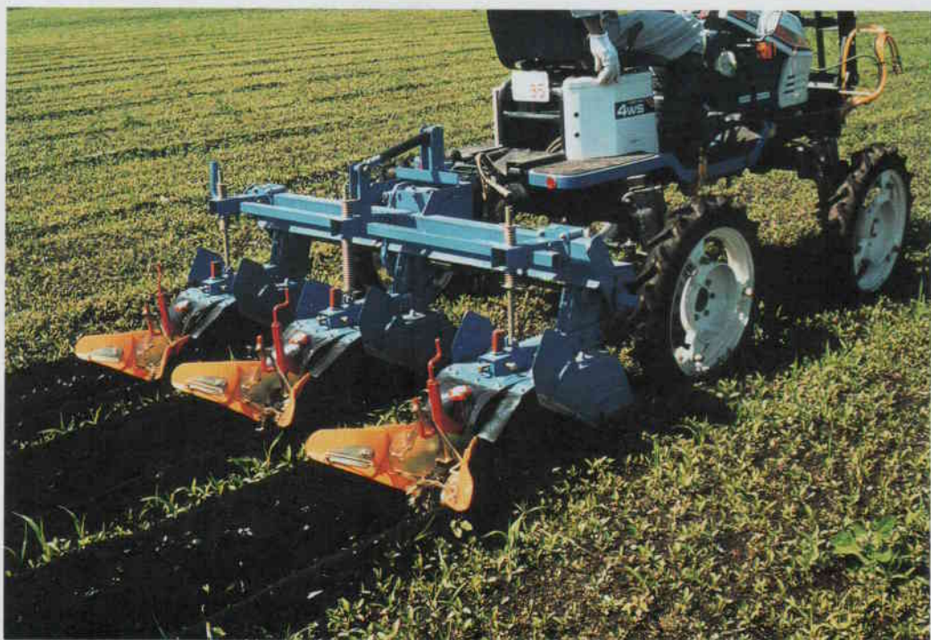
写真3 管理ビークルによる中耕・除草作業
