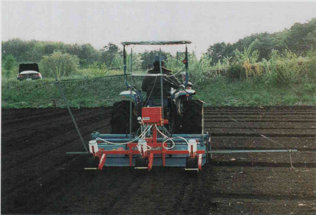
写真2 真空播種機による播種状況
