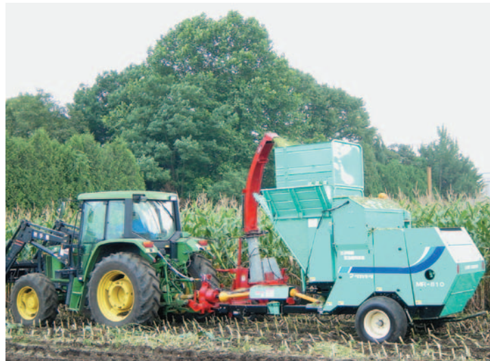
写真1 細断型ロールペーラ (85psトラクタ駆動, 2条刈りハーベスタ使用)
