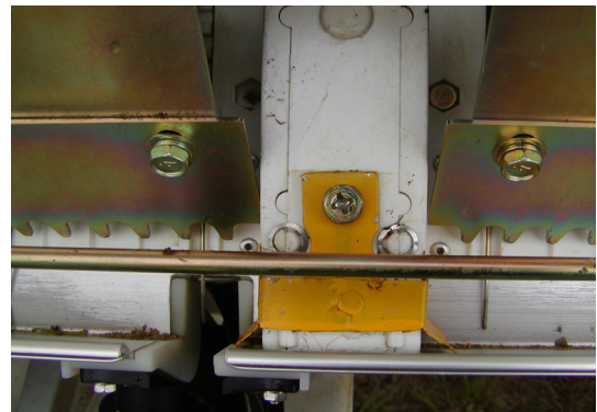
写真3 欠株低減化装置(掻き取り部直前で両側約10mmずつ狭めている)
