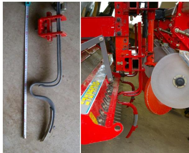
図12 チゼル爪に用いたトラックルーズナ部品(左)と装着した状態(右)
