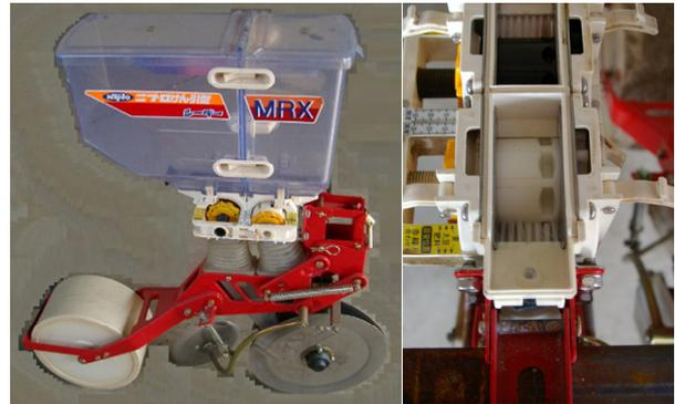
図 18 ロール式播種機(右図はロール部分)
