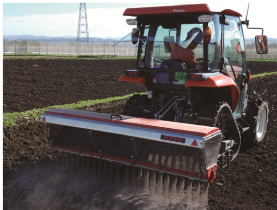
図77 ライムソーワによる転炉スラグ処理
