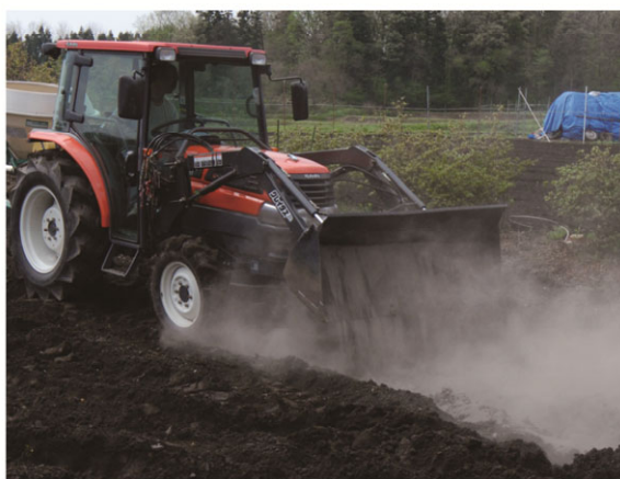
図76 フロントローダによる転炉スラグ処理
