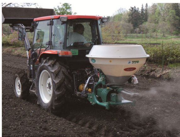
図75 ブロードキャスターによる転炉スラグ処理
