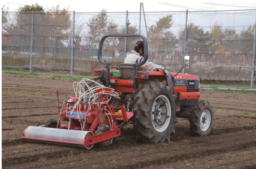
図45 クロルピクリンくん蒸剤を用いた深層土壌くん蒸処理の作業風景(2006.11.6)
