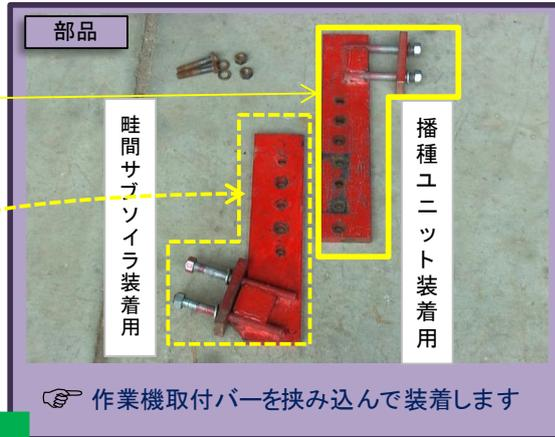
作業機取付バーを挟み込んで装着します
